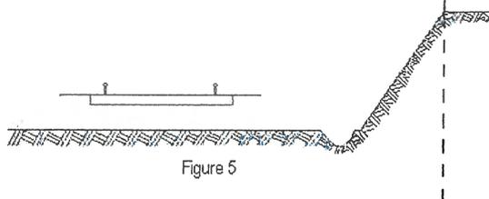
Dans le cas d'une voie posée à flan de coteau, la limite légale à considérer est constituée par le point extrême des déblais ou remblais effectués pour la construction de la ligne et non la limite du terrain naturel (figures 6 et 7).
